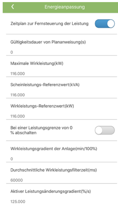
Abbildung 7-7 Leistungsanpassung (Spezieller Benutzer)
